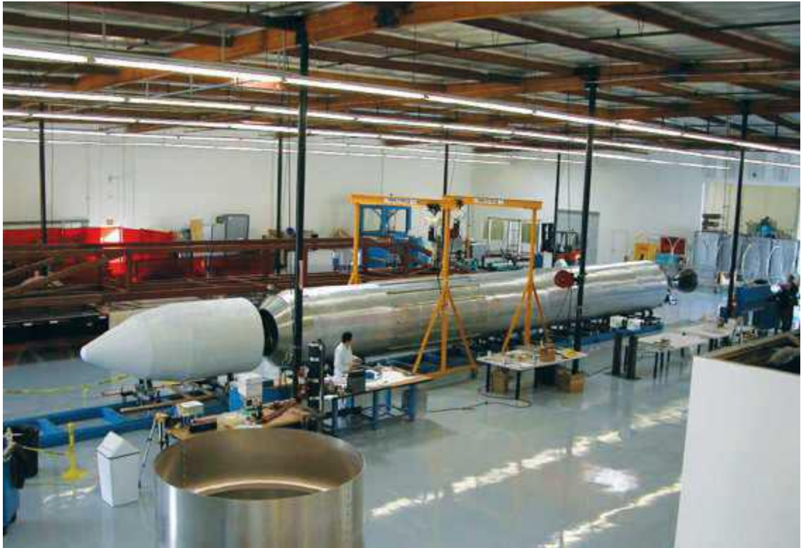
Сборка ракеты Falcon 1 на ракетном заводе, созданном SpaceX в бывшем авиазаводе в Лос-Анджелесе. Снимок предоставлен SpaceX.
